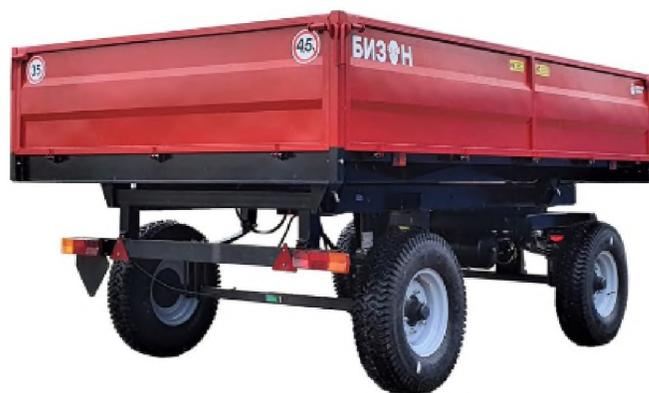
Тракторный самосвальный прицеп БИЗОН 2ПТС-4,5 предназначен для перевозки сыпучих и штучных грузов, массой не более 4,5т.
