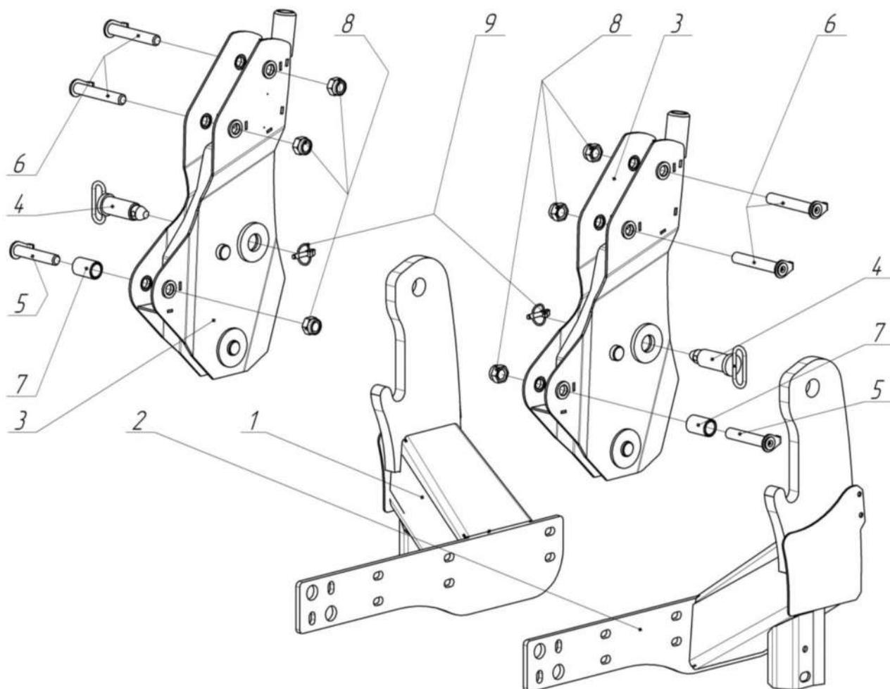
Рис. 2.1 – Сборка подрамников с БРС трактора
