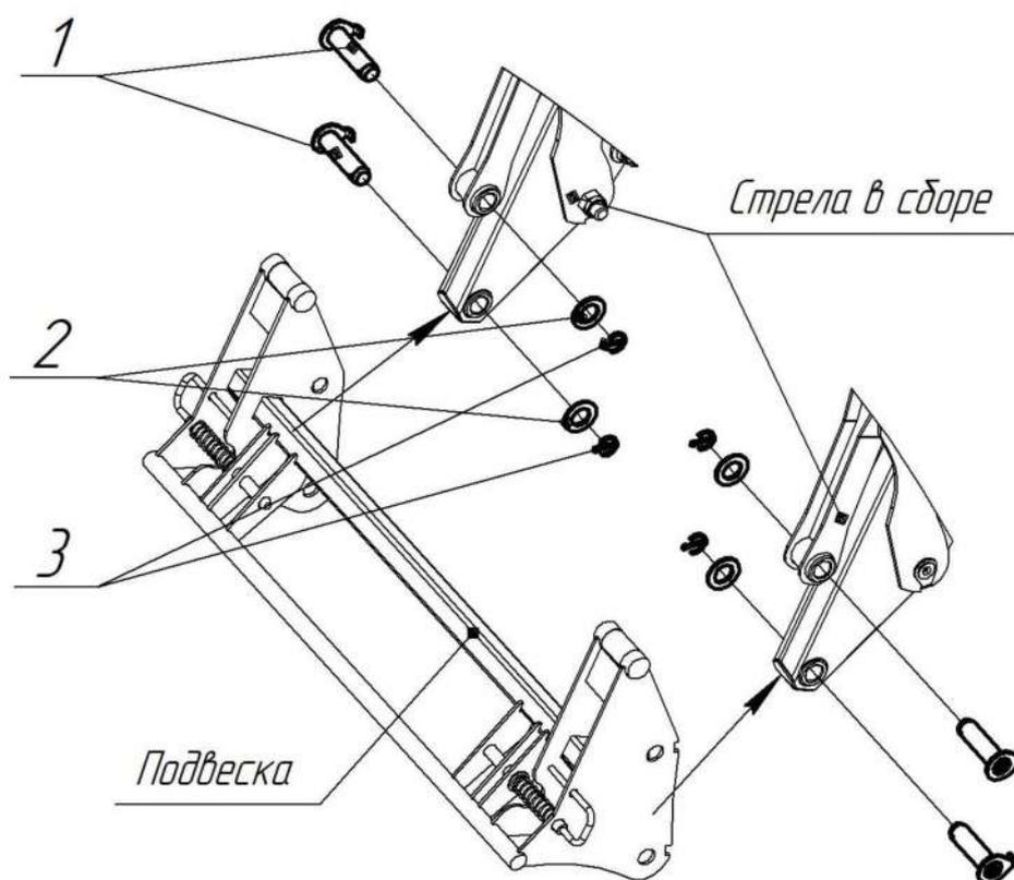
Рис. 5.4 – Комплект крепежа подвески или инструмента
