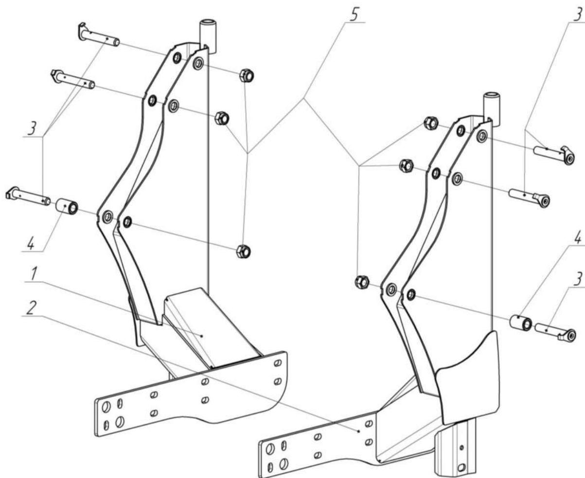
Рис. 2.2 – Сборка подрамников без БРС трактора
